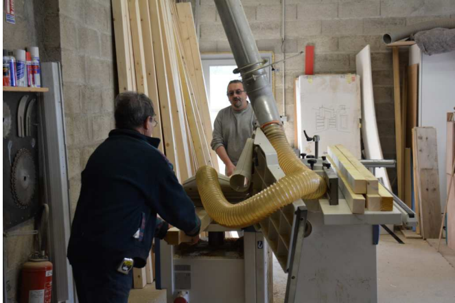
Corroyage d'un chevron brut
